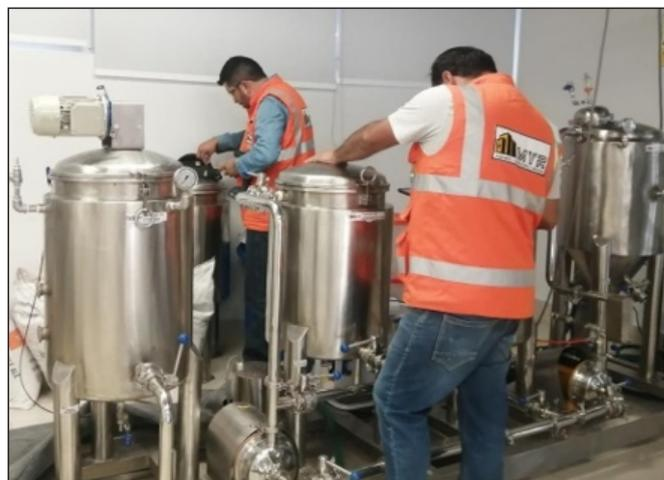
Remoción de las tapas de los tanques para proceder a la fusión de los componentes.
