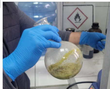
Digestión ácida de la biomasa de totora ( Schoenoplectus californicus ) como parte del análisis de fósforo acumulado en la planta. Tras secarse y triturarse, las muestras se procesan en el laboratorio para cuantificar cuánto fósforo retuvo la macrófita durante el experimento.
