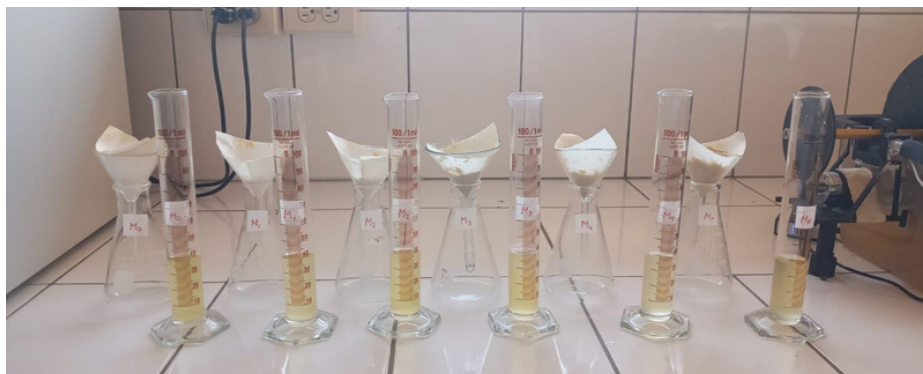
Filtración de las muestras en el Laboratorio de Análisis de Calidad del Agua de la Universidad de Cuenca. Las probetas graduadas y los embudos con papel filtro permitieron separar los sólidos del líquido para determinar la concentración de fósforo en cada tratamiento (M0 a M4 y el control MP).
