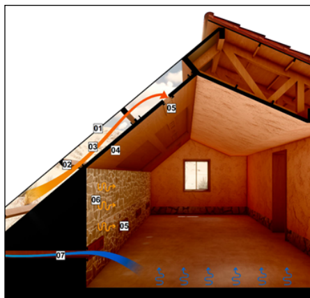
Innovación UTP. Módulo de vivienda con el sistema captador pasivo con convección de aire.
