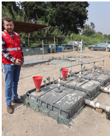
Innovación UTP. Docente Investigador Juan Pablo Gómez, mostrando el sistema de recuperación de biogás en funcionamiento.
